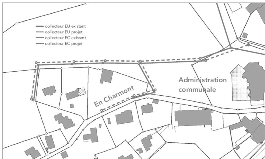
Les travaux consistent en la création d'une nouvelle canalisation pour les eaux usées et d'un assainissement de la canalisation existante.
